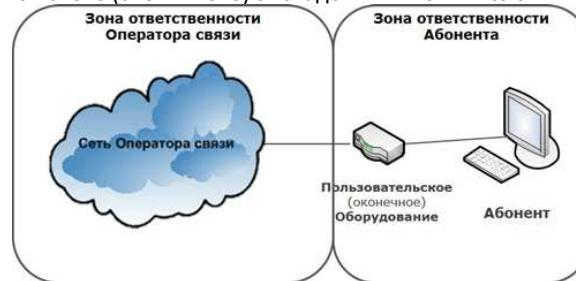
**СХЕМА ВКЛЮЧЕНИЯ ПОЛЬЗОВАТЕЛЬСКОГО (ОКОНЕЧНОГО) ОБОРУДОВАНИЯ ПО ТЕХНОЛОГИИ xPON**
