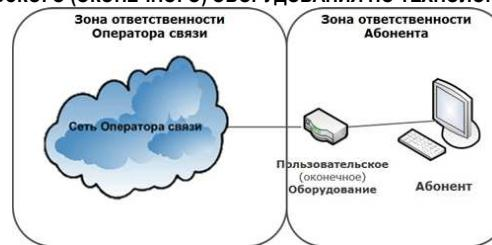
**СХЕМА ВКЛЮЧЕНИЯ ПОЛЬЗОВАТЕЛЬСКОГО (ОКОНЕЧНОГО) ОБОРУДОВАНИЯ ПО ТЕХНОЛОГИИ xPON**
