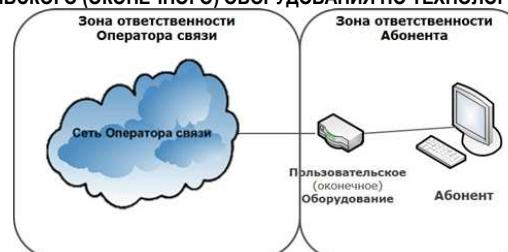
СХЕМА ВКЛЮЧЕНИЯ ПОЛЬЗОВАТЕЛЬСКОГО (ОКОНЕЧНОГО) ОБОРУДОВАНИЯ ПО xPON
