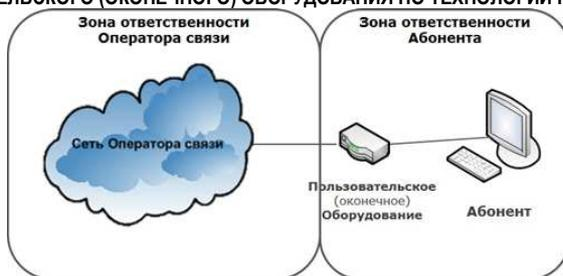
**СХЕМА ВКЛЮЧЕНИЯ ПОЛЬЗОВАТЕЛЬСКОГО (ОКОНЕЧНОГО) ОБОРУДОВАНИЯ ПО ТЕХНОЛОГИИ WNGN**
