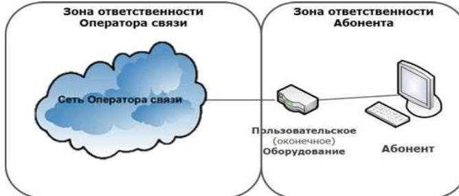
СХЕМА ВКЛЮЧЕНИЯ ПОЛЬЗОВАТЕЛЬСКОГО (ОКОНЕЧНОГО) ОБОРУДОВАНИЯ ПО ТЕХНОЛОГИИ WNGN
