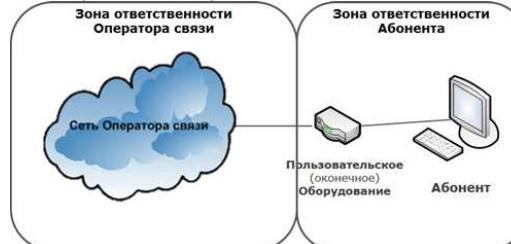
**СХЕМА ВКЛЮЧЕНИЯ ПОЛЬЗОВАТЕЛЬСКОГО**
