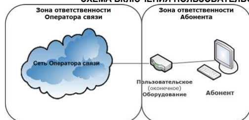
СХЕМА ВКЛЮЧЕНИЯ ПОЛЬЗОВАТЕЛЬСКОГО ТЕХНОЛОГИИ xPON
