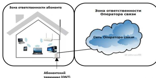
СХЕМА ВКЛЮЧЕНИЯ ПОЛЬЗОВАТЕЛЬСКОГО ТЕХНОЛОГИИ xPON
