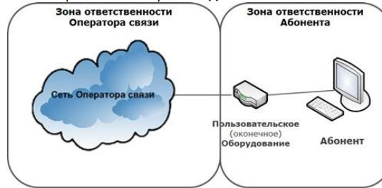
**СХЕМА ВКЛЮЧЕНИЯ ПОЛЬЗОВАТЕЛЬСКОГО (ОКОНЕЧНОГО) ОБОРУДОВАНИЯ ПО ТЕХНОЛОГИИ xPON**
