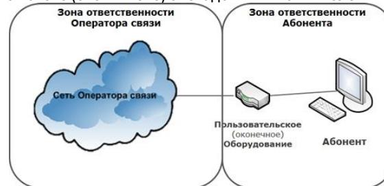
**СХЕМА ВКЛЮЧЕНИЯ ПОЛЬЗОВАТЕЛЬСКОГО (ОКОНЕЧНОГО) ОБОРУДОВАНИЯ ПО ТЕХНОЛОГИИ WNGN**
