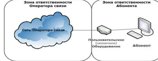
**СХЕМА ВКЛЮЧЕНИЯ ПОЛЬЗОВАТЕЛЬСКОГО (ОКОНЕЧНОГО) ОБОРУДОВАНИЯ ПО ТЕХНОЛОГИИ WNGN**
