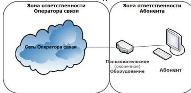
**СХЕМА ВКЛЮЧЕНИЯ ПОЛЬЗОВАТЕЛЬСКОГО (ОКОНЕЧНОГО) ОБОРУДОВАНИЯ ПО ТЕХНОЛОГИИ WNGN**
