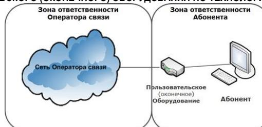
**СХЕМА ВКЛЮЧЕНИЯ ПОЛЬЗОВАТЕЛЬСКОГО**
