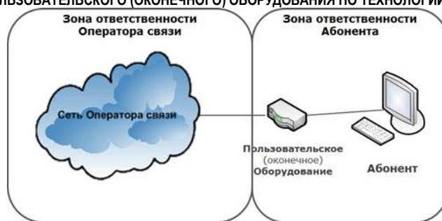
**СХЕМА ВКЛЮЧЕНИЯ ПОЛЬЗОВАТЕЛЬСКОГО (ОКОНЕЧНОГО) ОБОРУДОВАНИЯ ПО ТЕХНОЛОГИИ xPON**
