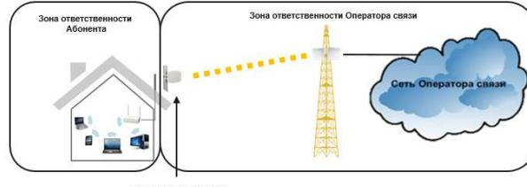
СХЕМА ВКЛЮЧЕНИЯ ПОЛЬЗОВАТЕЛЬСКОГО (ОКОНЕЧНОГО) ОБОРУДОВАНИЯ ПО ТЕХНОЛОГИИ xPON
