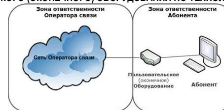
**СХЕМА ВКЛЮЧЕНИЯ ПОЛЬЗОВАТЕЛЬСКОГО (ОКОНЕЧНОГО) ОБОРУДОВАНИЯ ПО ТЕХНОЛОГИИ xPON**
