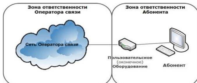
**СХЕМА ВКЛЮЧЕНИЯ ПОЛЬЗОВАТЕЛЬСКОГО (ОКОНЕЧНОГО) ОБОРУДОВАНИЯ ПО ТЕХНОЛОГИИ WNGN**
