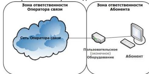
**СХЕМА ВКЛЮЧЕНИЯ ПОЛЬЗОВАТЕЛЬСКОГО (ОКОНЕЧНОГО) ОБОРУДОВАНИЯ ПО ТЕХНОЛОГИИ xPON**
