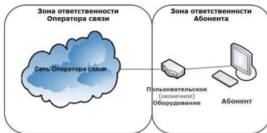
СХЕМА ВКЛЮЧЕНИЯ ПОЛЬЗОВАТЕЛЬСКОГО (ОКОНЕЧНОГО) ОБОРУДОВАНИЯ ПО ТЕХНОЛОГИИ xPON
