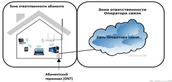
СХЕМА ВКЛЮЧЕНИЯ ПОЛЬЗОВАТЕЛЬСКОГО (ОКОНЕЧНОГО) ОБОРУДОВАНИЯ ПО ТЕХНОЛОГИИ xPON
