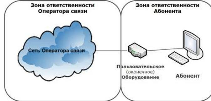
**СХЕМА ВКЛЮЧЕНИЯ ПОЛЬЗОВАТЕЛЬСКОГО (ОКОНЕЧНОГО) ОБОРУДОВАНИЯ ПО ТЕХНОЛОГИИ xPON**
